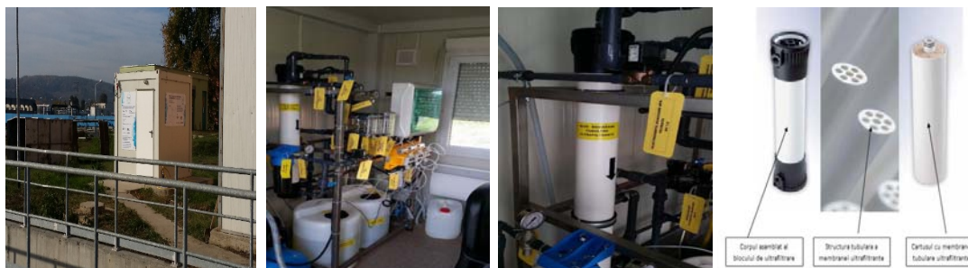
Figura 27. Sistemul pilot de epurare avansată prin ultrafiltrare a efluentului rezultat de la epurarea biologică (locație SC APAVITAL Iași)
